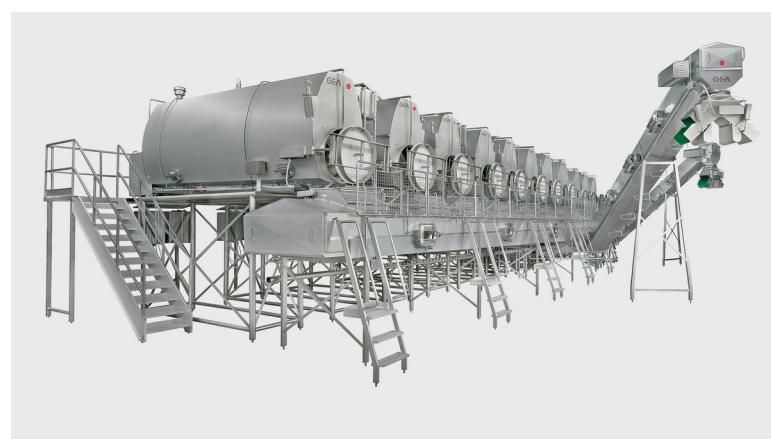
GEA предлагает широкий ассортимент современных автоматизированных систем для удаления сыворотки и созревания сырной массы, используемых при производстве различных видов сыра паста филата. Доступны системы для периодического и непрерывного технологического процесса объемом до 1250 кг.
