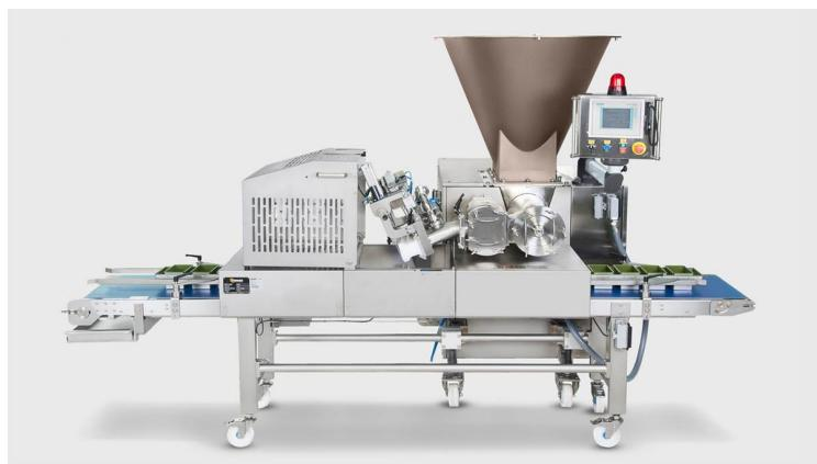
Устройство идеально подходит для пекарен малого и среднего размера, которые хотят повысить точность и скорость обработки липких тестовых смесей, которые трудно обрабатывать и отсаживать.
