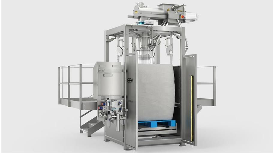
Аппарат GEA HYGiBulk C1 предназначен для применения на участках, где мешки фасуются на поддонах. Его компактные размеры идеально подходят для клиентов, которым требуется решение для ручной фасовки сыпучих материалов, когда поддоны допускаются в помещение для фасовки.
