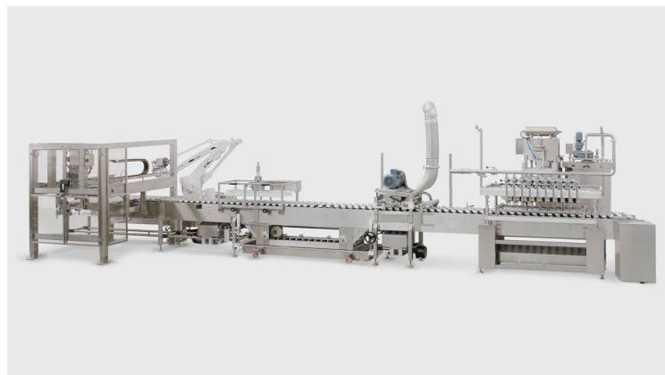
Система может быть интегрирована в существующую линию производства багетов и обладает многими полезными функциями, в том числе функцией автоматического отключения дозирования при отсутствии продукта с системой рециркуляции для сведения к минимуму потерь и сокращения времени простоя для очистки.
