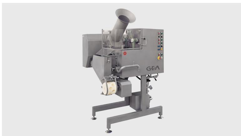
GEA разработала данную многофункциональную систему MINICOMPACT по вытягиванию и формованию сырной массы для небольших молочных заводов и для опытных или научно-исследовательских предприятий по производству вытяжных сыров. Предназначенные для серийного производства машины MINICOMPACT состоят из устройства для нарезки сырной массы, варочно-вытяжной ванны с погружными рычагами и устройства для формовки сыра в составе одного агрегата производительностью до 100 кг/ч.
