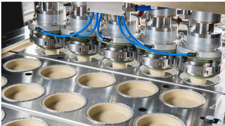
Системы для изготовления пирогов моделей LTT и LTF представляют собой высокопроизводительные настраиваемые машины для промышленного производства тарталеток или пирогов. Система LTT отсаживает и формует пироги на противнях с углублениями, которые затем поступают в туннельные печи GEA, тогда как система LTF формует пироги в отдельных формах.
