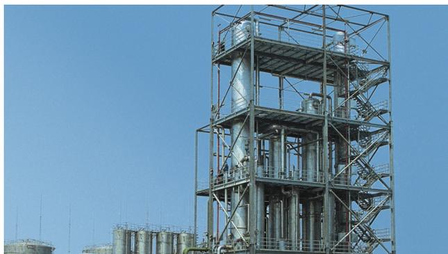
Основным оборудованием среди широкой номенклатуры продукции для дистилляции является многоступенчатая система вакуумной ректификации и ректификации при избыточном давлении. Конструкция во многом определяется характерными свойствами подачи и конкретными требованиями конечного продукта.
