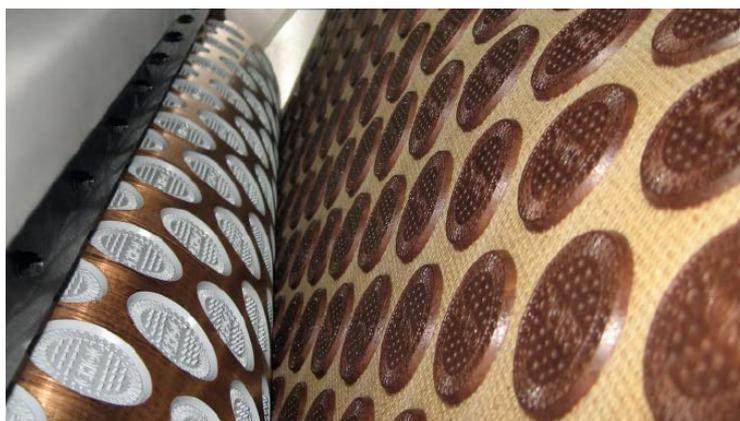
Высочайшая производительность в сочетании с точным контролем массы каждой порции теста. Ротационная формовочная машина может быть адаптирована ко всем требованиям производства, чтобы стать частью целой производственной линии для выпуска широкого ассортимента печенья.
