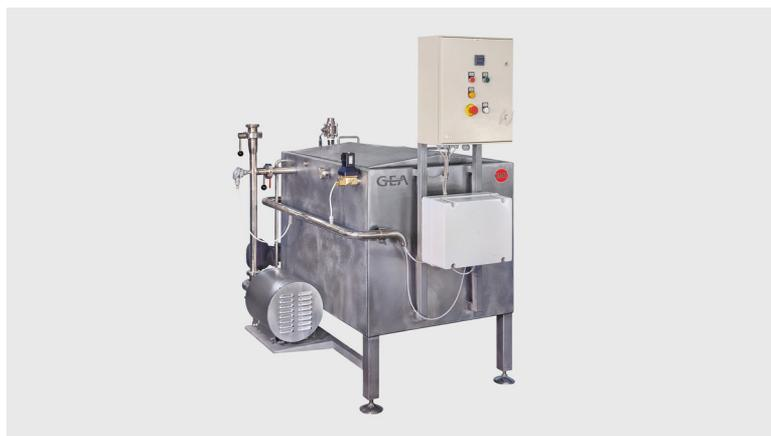
GEA разработала серию водонагревателей для удовлетворения любых производственных потребностей и под любые мощности для обработки сыра паста филата. Наша 200-литровая водонагревательная ванна для прямой обработки острым паром может нагревать 350 литров воды до температуры от 10°C до 85°C каждый час, работая при давлении пара 3 бара. Терморегулируемая система оснащена инжектором с глушителем в трубопроводе подачи водяного пара и электромагнитным клапаном.
