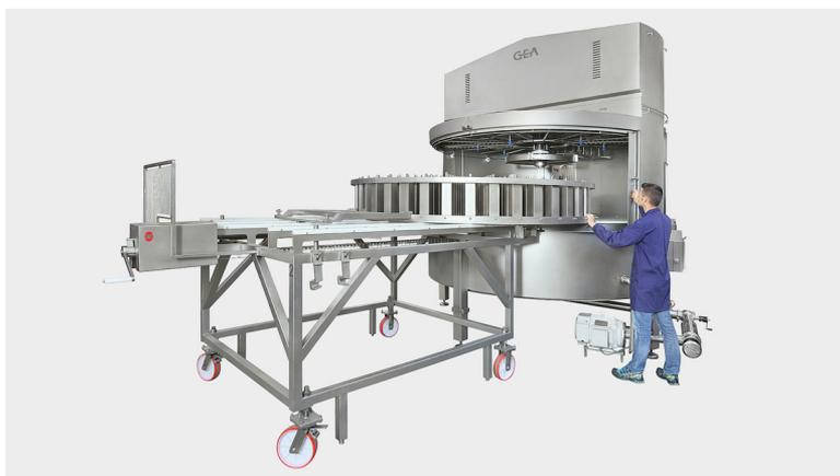
Когда карусель вращается, продукт подвергается предварительному отверждению посредством распыления холодной воды, а в конце вращения формы выгружаются в ванну для отверждения. Охлаждающая вода проходит через теплообменник и циркулирует в контуре с помощью центробежного насоса.
